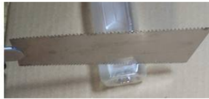
ペットボトルの四つの角にノコギリで切れ目を入れる
